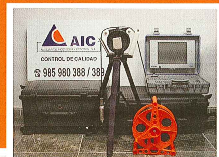
Dispositivo de auscultación de pilotes
